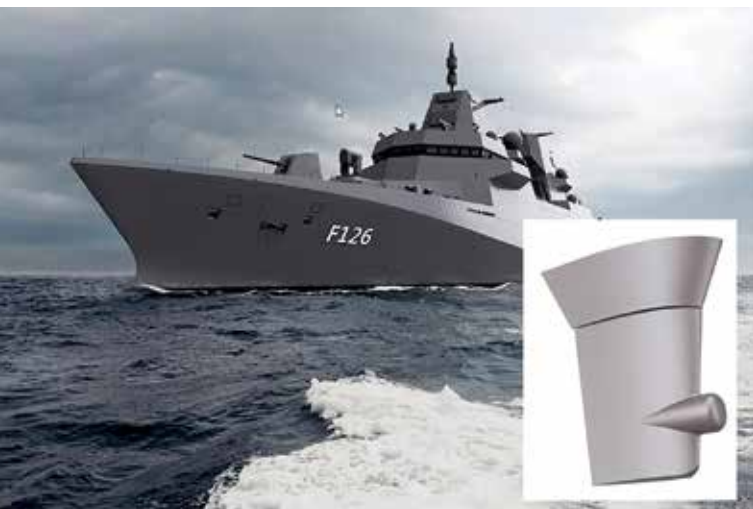
Die Vollspatenruder vom Typ Atlantic verringern mit ihrem schlanken Profil den Strömungswiderstand und verbessern die Kurshaltung bei hohen Geschwindigkeiten.
